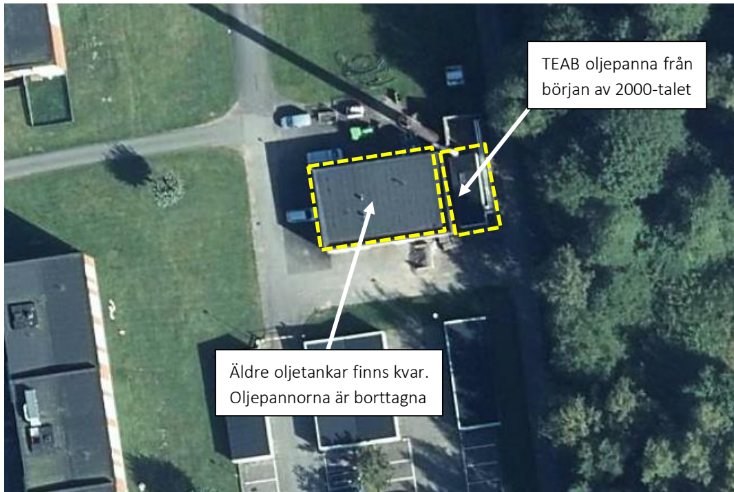
Figur 4. Lokalisering av tidigare och nuvarande oljetankar och pannor
