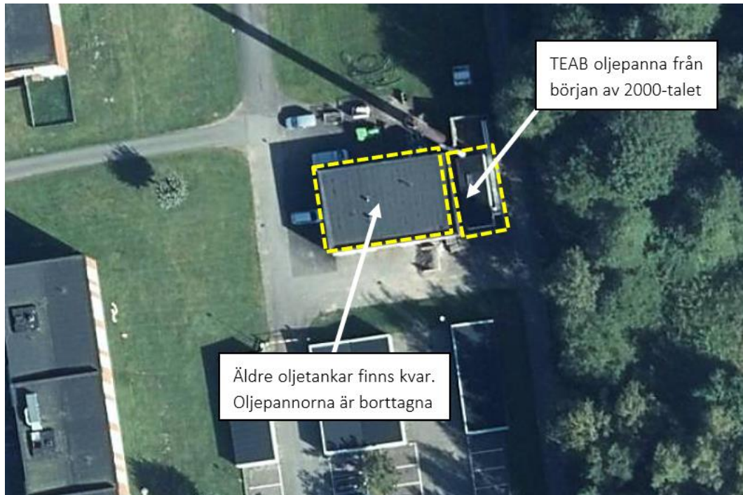
Figur 6. Lokalisering av tidigare och nuvarande oljetankar och pannor.
