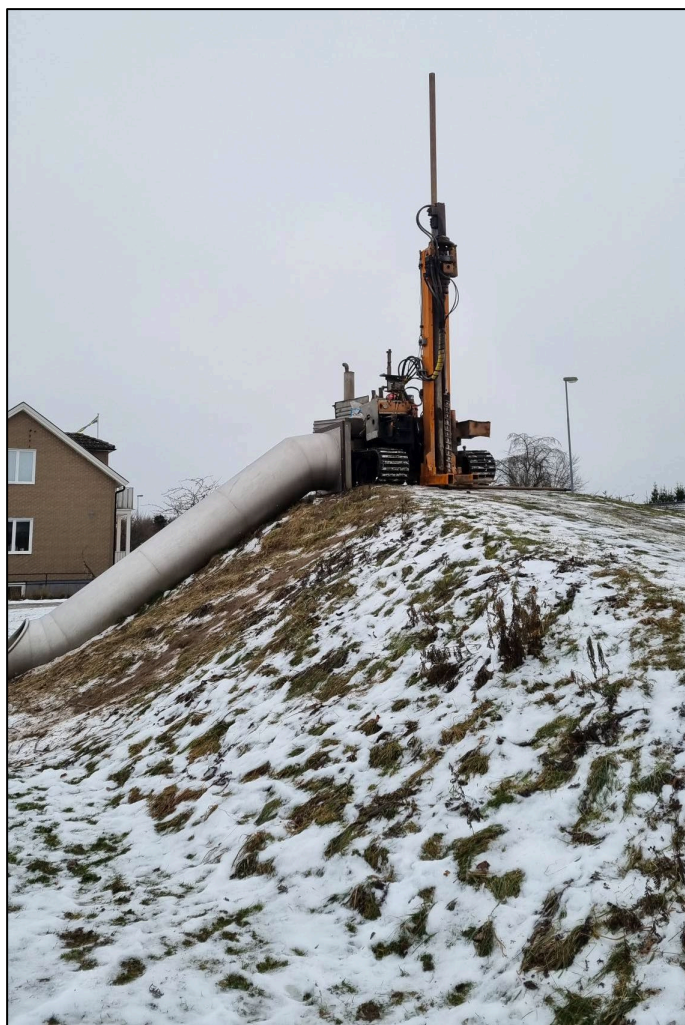
Figur 3. Foto på borrhvagn 22MS09 för provtagning av fyllnadsmaterialet i pulkabacken.
